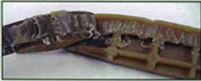
SBS Material ( F = 12,7 \text{ N/mm} ) mit Materialbruch
