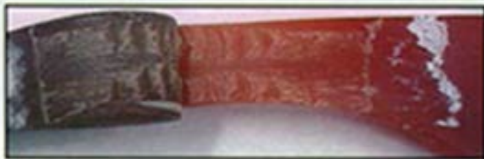
EPDM Material ( F = 10,2 \text{ N/mm} ) mit Materialbruch
