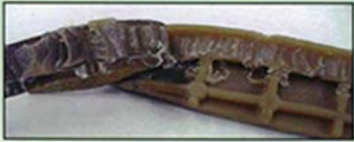
SBS Material ( F = 12,7 \text{ N/mm} ) mit Materialbruch
